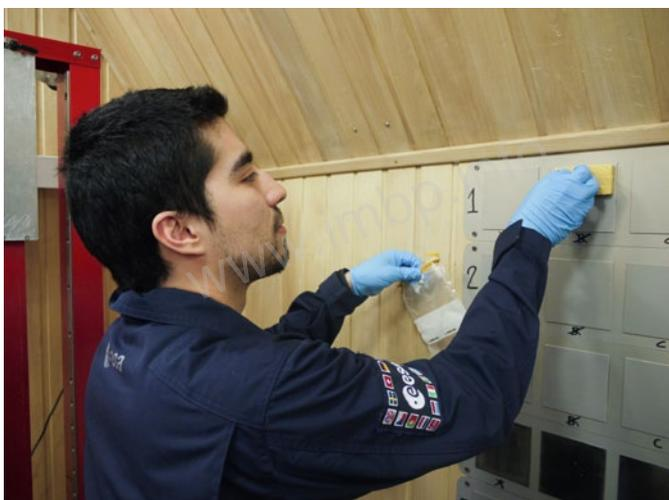
Диего Урбина выполняет сбор микрофлоры с образцов обшивок, используемых в орбитальных модулях космической станции
